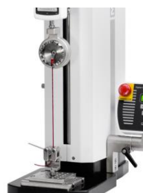
Testare terminale cabluri
