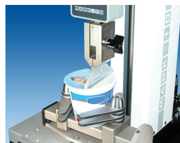
Testare dezlipire folie etansare
