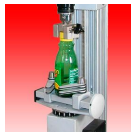
Masurare deschidere capace pe stand
