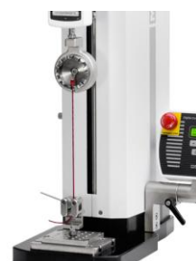
Testare terminale cabluri
