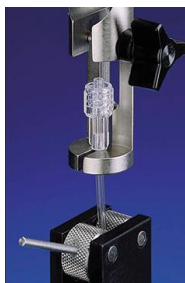
Testare extragere terminale plastic
