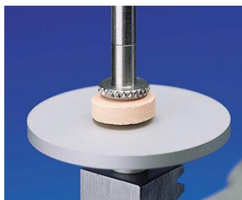
Testare compresiune tablete
